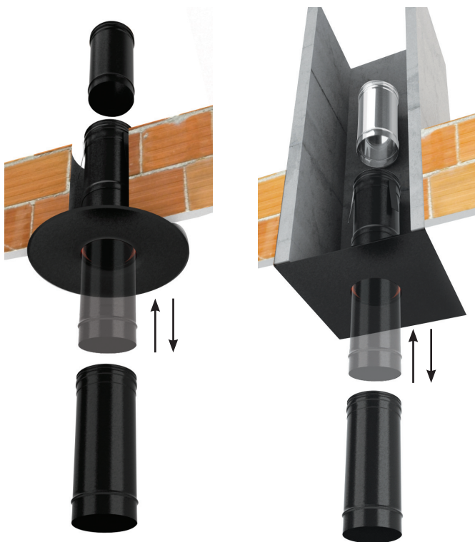
ESEMPIO DI INSTALLAZIONE DEL RACCORDO PASSANTE TELESCOPICO CON ROSONE ROTONDO
